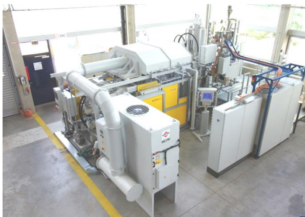
Abbildung 2: DirCom-Prototyp-Anlage bei Neue Materialien Fürth GmbH. 400 t Schließkraft, Holmabstand 580 mm x 620 mm, Schussgewicht max. 1 kg Magnesium
